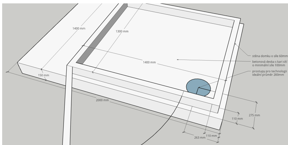
Základ pro domek s tepelným čerpadlem na levé straně
